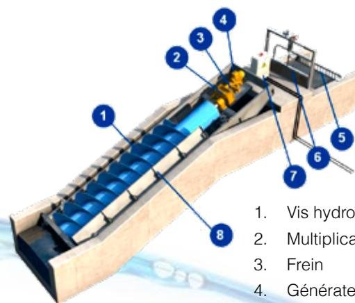
1. Vis hydroélectrique
